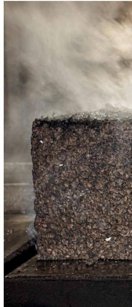
Die wärme- und kältedämmende Wirkung von Kork bleibt über Jahrzehnte stabil. Sie beruht auf der geringen Wärmeleitfähigkeit von 0,040 W/mK. Die hervorragenden Eigenschaften aufgrund des Aufbaus der Zellen und ihrer chemischen Eigenschaften werden bis heute oft kopiert, aber kaum erreicht.
