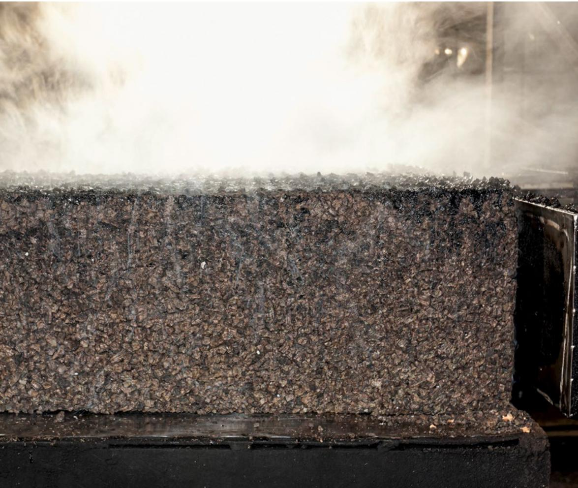
Das für die Herstellung von Bio-Korit verwendete Korkgranulat (Korkrindenreste) wird unter Zufuhr von ca. 370 °C heissem Wasserdampf und unter Druck zu Platten gebacken. Durch die hohe Temperatur treten die natürlichen Harze aus den Zellen aus. Die Zellen vergrössern sich, sie expandieren und binden sich durch das eigene Harz. Die Dämmeigenschaften des Naturkorks werden so erhöht, und die Dämmplatten kommen ohne zusätzliche Klebstoffe aus.
