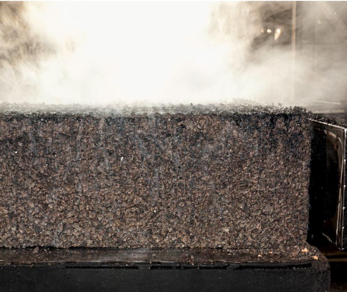
Le granulé de liège utilisé pour la production de Bio-Korit (restes d'écorce de liège) est cuit sous vapeur chaude à une température d'environ 370 °C et sous pression pour former des panneaux. La température élevée fait que les résines naturelles s'échappent des cellules. Les cellules s'agrandissent, se dilatent et se lient par leur propre résine. Les propriétés isolantes du liège naturel sont ainsi augmentées et les panneaux isolants n'ont pas besoin de colles supplémentaires.
